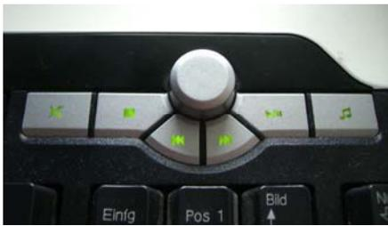
Abb.4: Audiosteuerung Computertastatur (Dell)
