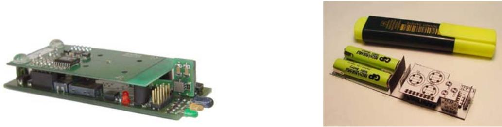
Abbildung 1: Originalversion des BlueWand mit aufgesetztem Bluetooth-Modul und orthogonalen Sensoren (links). Entwurf der miniaturisierten Variante, die ab Ende Februar einsatzbereit sein wird (rechts)
