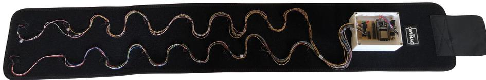
Abb. 1: Rückseite des Vibrationsgürtels mit Elektronik
