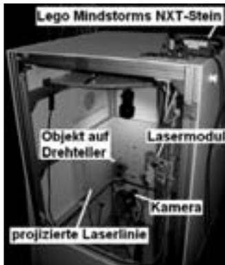
Abbildung 1: Messstand
