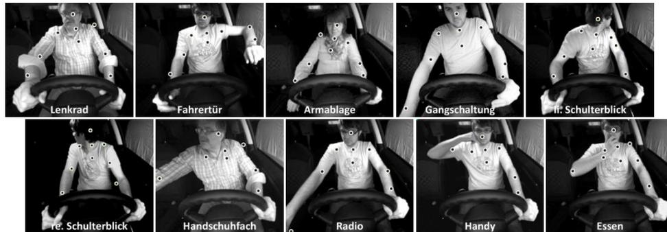
Abbildung 4: Erfassung der Oberkörperpose bei zehn Fahreraktivitäten. Die Punkte zeigen die erfassten Positionen, die zurück von der 3D-Position in das Aufnahmebild projiziert wurden.
