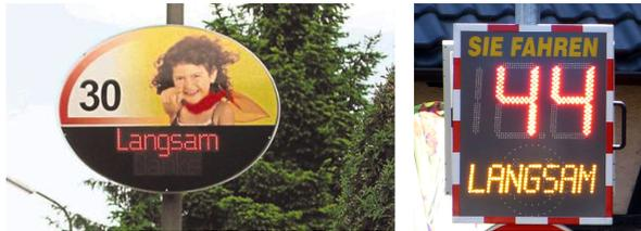
Abbildung 3: Dialog-Display (links) und numerische dynamische Geschwindigkeitsanzeigen (rechts)
