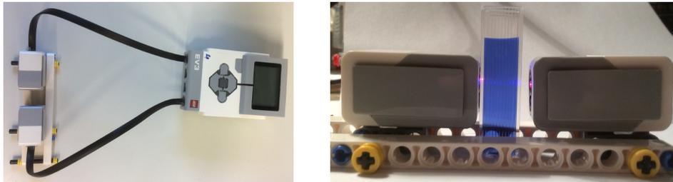
Abb. 2: Aufbau des Experiments mittels Stein, zwei Lichtsensoren und Kvettenhalterung für photometrische Messungen
