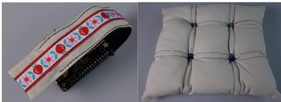
Abbildung 1: Ausgewählte Sensorkonzepte: Erfassung der Eigenbewegung mittels Beschleunigungssensoren (links), Erfassung des Mikroklimas mittels Temperatur- & Feuchtigkeitssensoren in der Klimadecke
