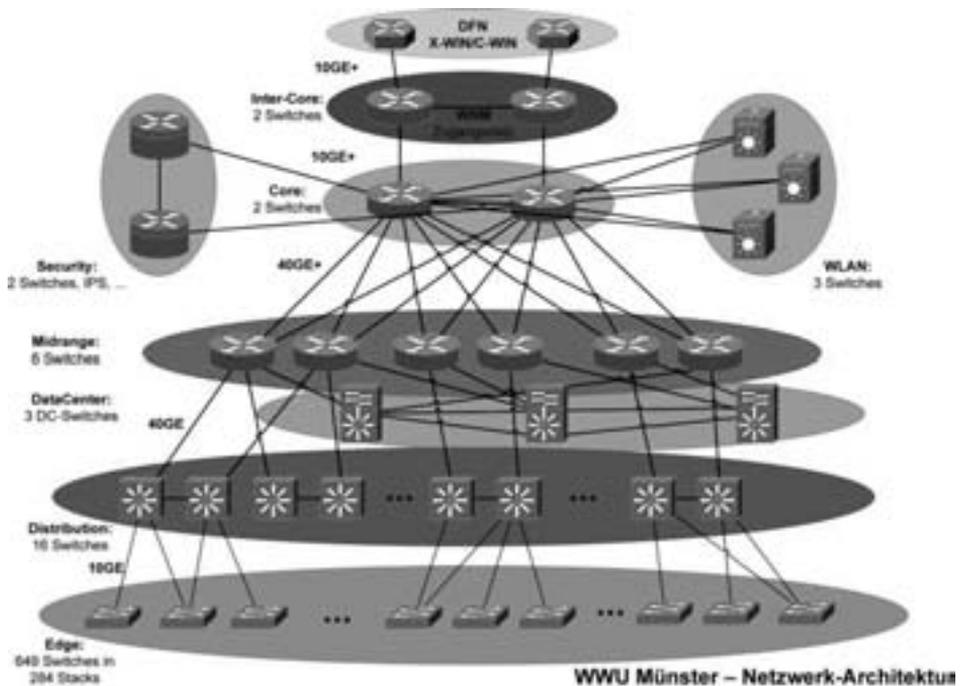
Abb.1: Schematische Darstellung der Architektur mit Core (samt zentraler Security und WLAN Switching) – Midrange (samt Data Center) – Distribution – Edge
