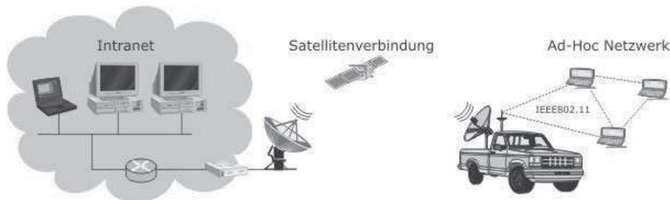
Abbildung 2: Mobilkommunikation mit Ad-Hoc Netzen und Satellitenanbindung
