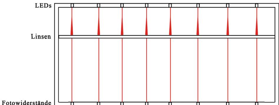
Abb. 3: Aufbau der Lichtharfe
