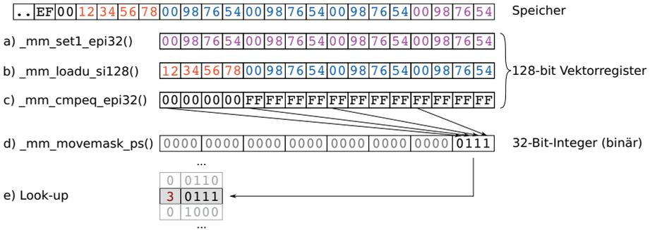
Abbildung 5: Darstellung ausgewählter Schritte des Kompressionsalgorithmus RleSimd an einem Beispiel. Alle Werte außer dem letzten sind in hexadezimaler Notation dargestellt. Adressen wachsen von rechts nach links. Oben: Ein Auszug des Speichers, der den Beginn der unkomprimierten Eingabedaten zeigt. Darunter: Registerinhalte nach Zwischenschritten des Algorithmus.
