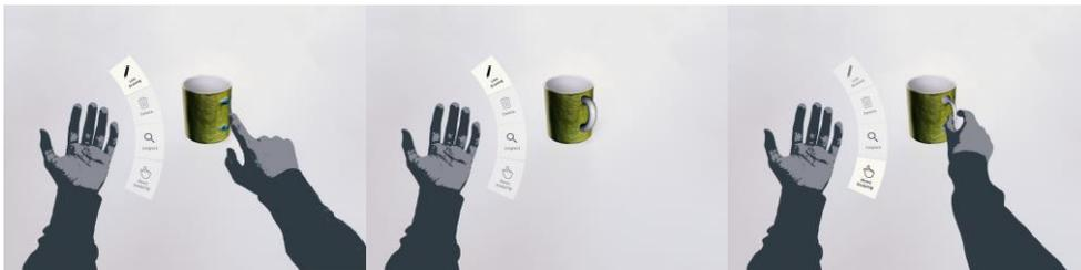
Abb. 2: Nutzer zeichnet Basislinie des Henkels (a); Algorithmus generiert auf Basis der Zeichnung und des Meshs ein Rohmodell (b); Nutzer modifiziert das Modell durch Direct Sculpting (c)
