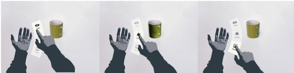
Abb. 1: Nutzer wählt die den Scan-Modus zum Scannen der Tasse (a); das Resultat des Scans wird dargestellt und der Nutzer kann in den Sculpting-Modus wechseln (b); das fertige Modell des Henkels kann gedruckt werden (c)
