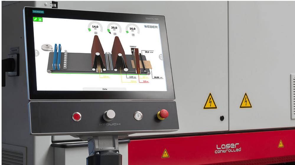
Abbildung 2: Siemens SIMATIC HMI Comfort PRO Panel
