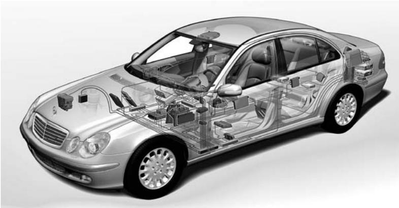
Abbildung 1: Mercedes-Benz E-Klasse mit verbauten Steuergeräten
