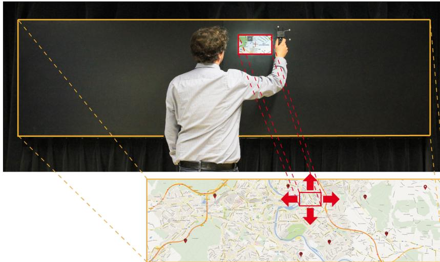
Abb. 2: Experimenteller Versuchsaufbau zur Simulation einer Dynamic Peephole Interaction auf einem großen vertikalen Bildschirm. Diese Simulation erlaubt es, die Wirkung von Peephole-Navigation auf Kartennavigation mit hoher interner Validität. Es vermeidet Störfaktoren wie Gewicht und Auflösung bestimmter Geräte.
