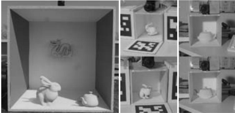
Abbildung 5: Links: Mehrere virtuelle Objekte befinden sich in einer realen Cornell Box. Mitte: Konsistente Beleuchtung unter zeitlich und räumlich variierendem Licht, der Benutzer kann interaktiv Kamera und Objekt bewegen. Rechts: Vergleich zwischen einem realen Teapot (oben) und einem virtuellen Teapot (unten).
