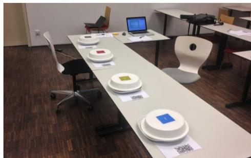
Abbildung 2: Versuchsaufbau mit farblich markierten Portionen und Bürostühlen für den Probanden (schwarz) und den Versuchsleiter (grau)
