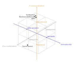
Abb. 1: Designraum der Protokolle für Off-Chain Berechnungen: Dimensionen und Ausprägungen.
