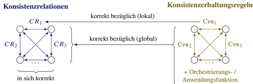
Abb. 3: Verschiedene Korrektheitsbegriffe für Konsistenz und Konsistenzerhaltung (vereinfacht aus [KI21, Fig. 4.4]): Metamodelle (Kreise), Konsistenz-(erhaltungs-)regeln (bidirektionale Pfeile).
