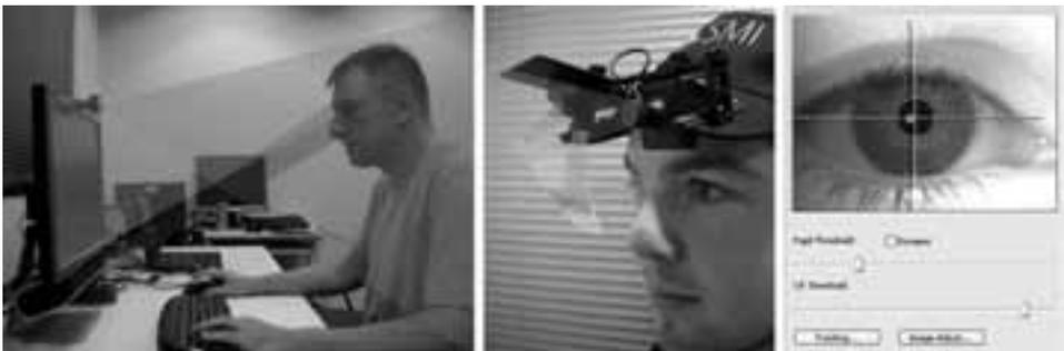
Abbildung 1: links: Funktionsweise des RED-Systems; mitte: Funktionsweise des HED-Systems; rechts: über HED-System erkanntes Auge mit Fadenkreuz für Pupille und Reflexpunkt.
