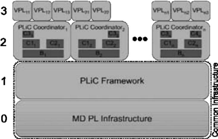
Abbildung 2: Infrastruktur zur Erstellung hierarchischer modellgetriebener Produktlinien
