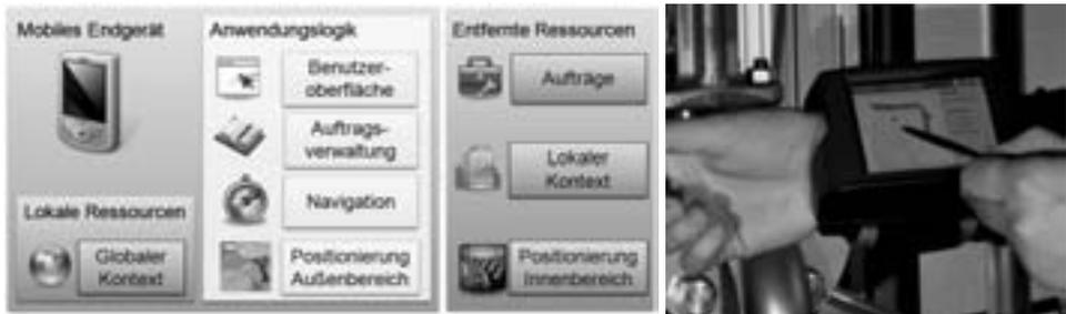
Abbildung 1: Systemarchitektur der Navigationsanwendung (links) sowie Nutzung der Anwendung im Feld (rechts)
