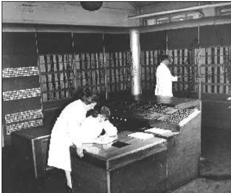
Abbildung 6: Arbeit am Commandopult der OPREMA; im Hintergrund wird ein Programm gesteckt.. Die Stecktafelprogrammierung macht deutlich, dass das von-Neumann-Prinzip noch nicht realisiert wurde.
