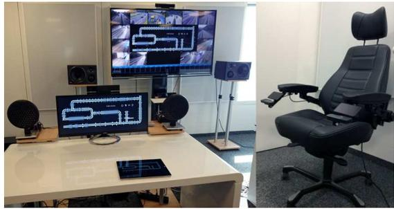
Abbildung 2: Demonstrator-Setup mit gerichteten Lautsprechern und Operatorsessel.
