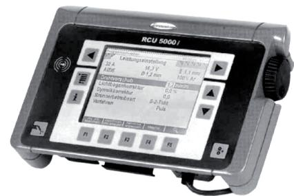
Abbildung 4a: Foto der Steuereinheit
