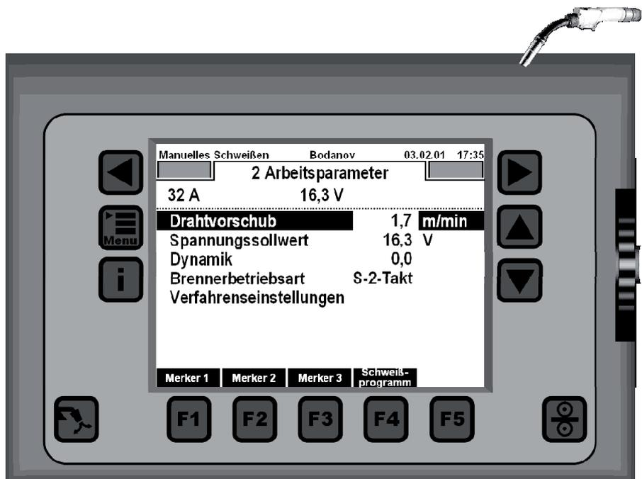
Abbildung 4b: Prototyp der Steuereinheit in Powerpoint
