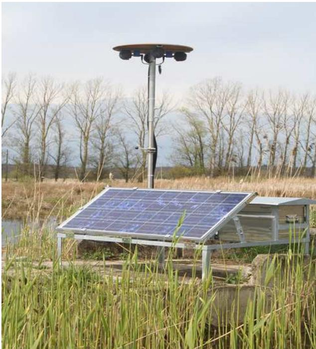
Abbildung 1: Solargespeiste autonome Aufzeichnungseinheit zur Langzeiterfassung von Tierstimmen. Die Tonaufzeichnungen erfolgen im Rahmen eines Langzeitmonitorings einer Moor-Renaturierungsfläche in Mecklenburg-Vorpommern. Die Aufzeichnungen erfolgen zeitgetriggert mit einem Mehrkanalrecorder mit vier Mikrofonen mit Nierencharakteristik (Foto K.-H. Frommolt).
