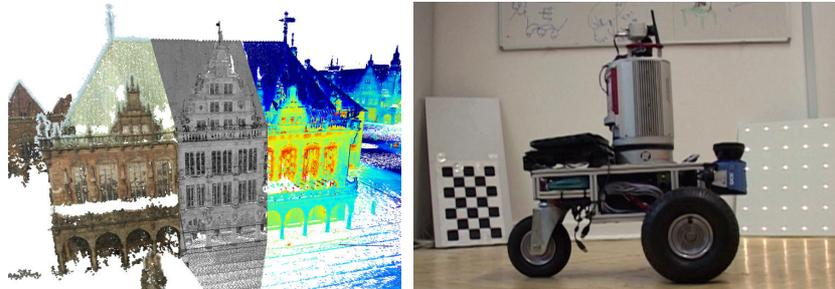
Abb. 1: Links: Skizze eines multi-modalen Modells des Bremer Rathauses, eine Punktwolke mit Temperatur- und Farbinformationen. Rechts: Der Roboter Irma3D vor den Kalibrieremustern.
