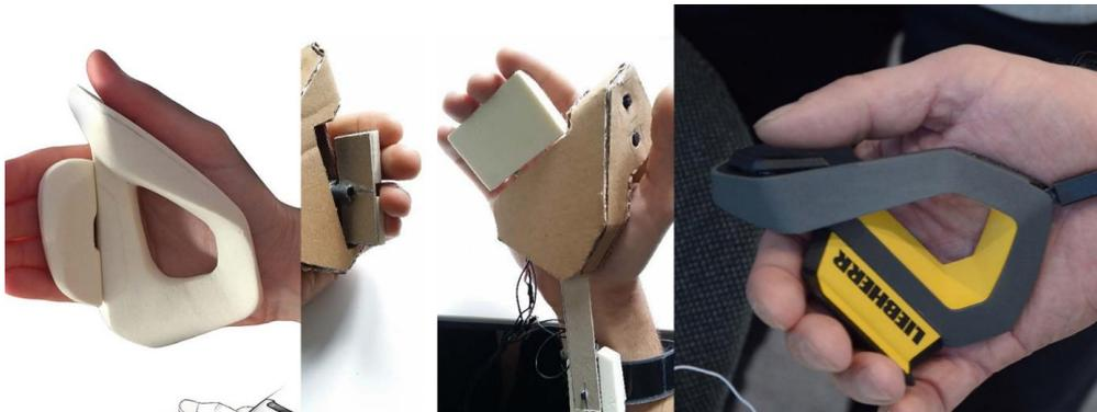
Abbildung 3: Finale Prototypen der Handfernbedienung (links) und virtuelles Bedienszenario (rechts)
