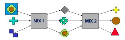
**Abbildung 4:** Mix-Prinzip: Datenpakete werden gepuffert, umkodiert und umsortiert – die Ein
