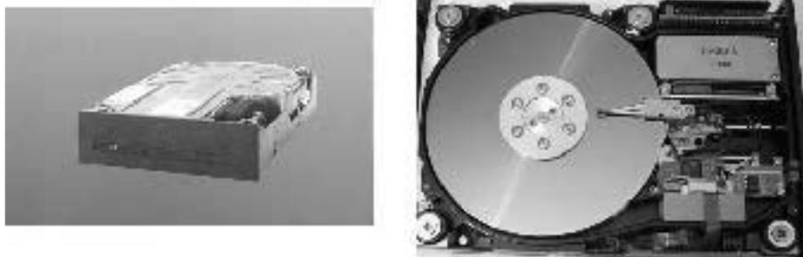
Abbildung 15: Der 5 1/4"-Festplattenspeicher K 5504
