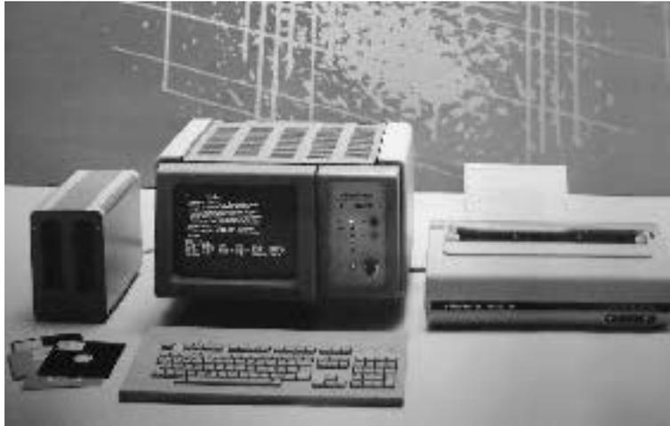
Abbildung 9: Die konfigurierbare Datenstation K 8915
