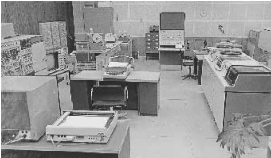
Abbildung 4: HRA 7000 System: links ADT300 mit Analogperipherie und Bedienschreibmaschine, im Hintergrund Lochbandstation und R4000, rechts Plattenstrecke
