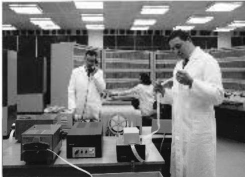
Abbildung 2: BESM 6 im Willersbau der TU Dresden, Eingabe über Lochkarten, Ausgabe über Lochstreifen zur Simulation und Optimierung von Klima- und Kälteanlagen mit dem Blockorientierten Simulations-System BORIS 1
