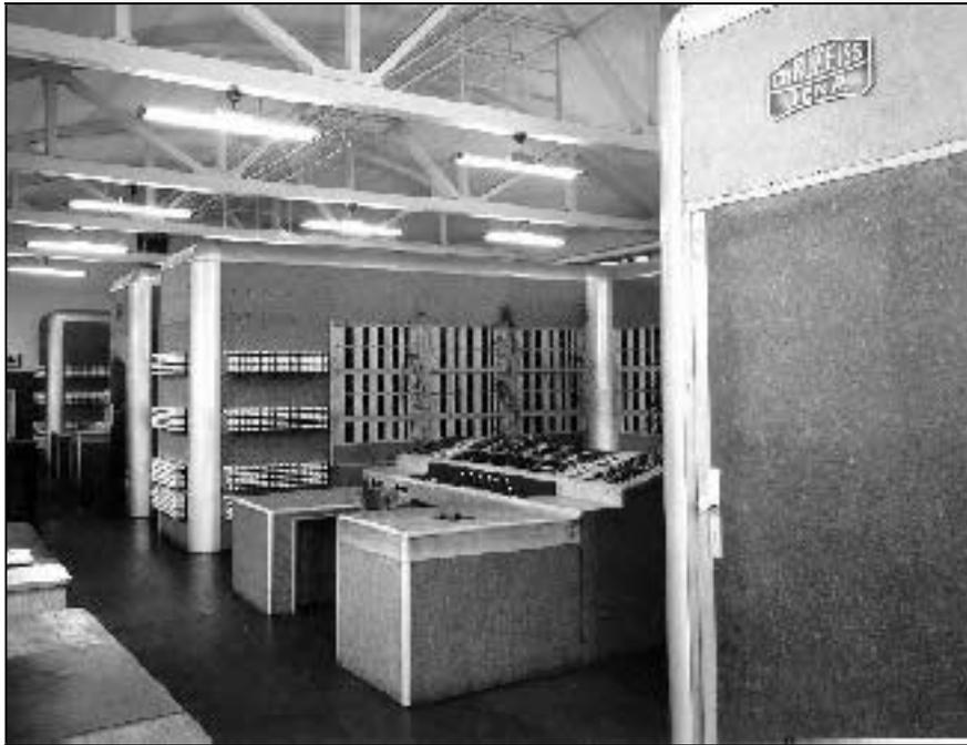
Abbildung 2: Programmgesteuerte Rechenanlage OPREMA VEB Carl Zeiss Jena 1954
