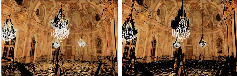
Abb. 4: Ein Scan aus dem Kaisersaal der Würzburger Residenz eingefärbt aus Fotos ohne (links) und mit (rechts) Korrektur mittels Raytracing. (Video: <http://youtu.be/jKVx1LvU7Pk>).
