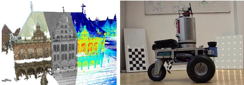
Abb. 1: Links: Skizze eines multi-modalen Modells des Bremer Rathauses, eine Punktwolke mit Temperatur- und Farbinformationen. Rechts: Der Roboter Irma3D vor den Kalibrierungsmustern.
