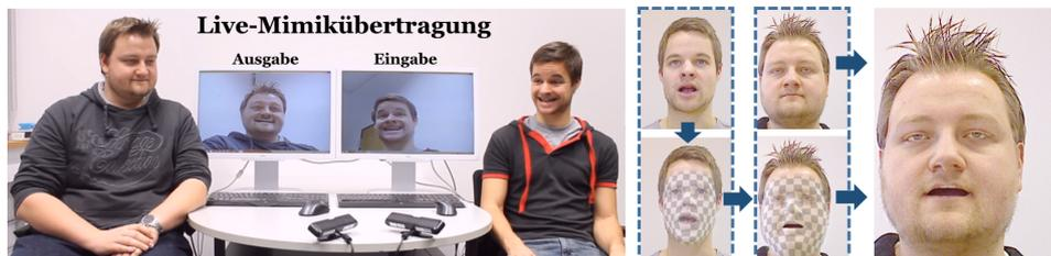
Abb. 4: Echtzeit Übertragung von Gesichtsausdrücken mit Hilfe von speziellen RGB-D Kameras.
