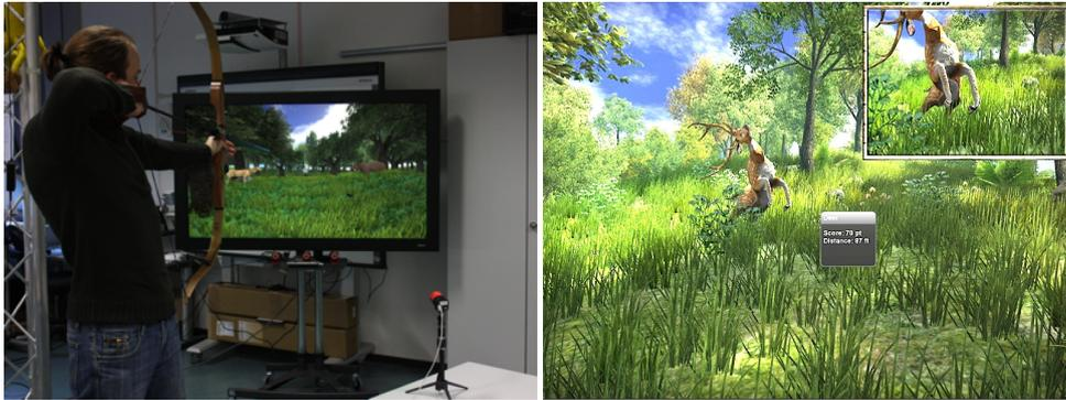
Abbildung 1: Prototyp des Bogensimulators im Labor, Bildschirmabzug einer realistischen Szene
