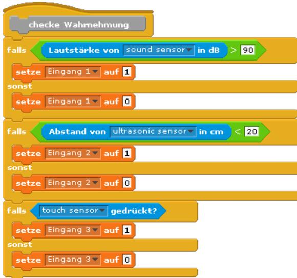
Abbildung 8 : Wahrnehmungen des Roboters
