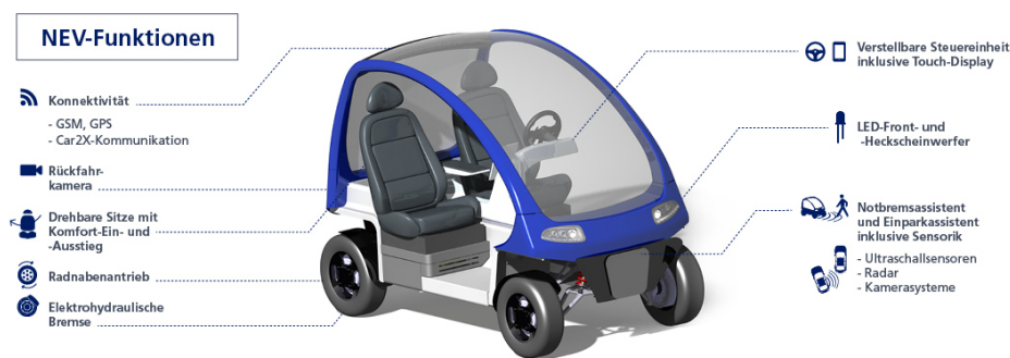
Abbildung 1: Das Neighbourhood Electric Vehicle (kurz NEV)
