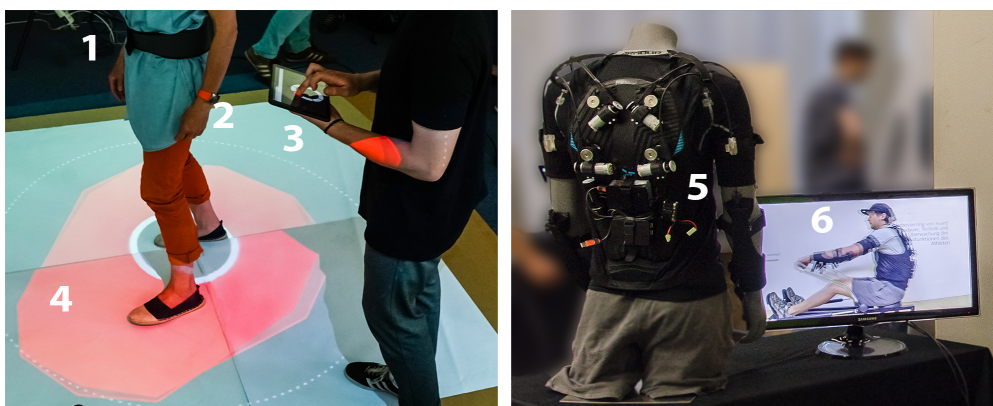
Abbildung 2: Modern Replacement (links), LYNE Rowing Suit (rechts), (1) Vibrationsgürtel, (2) Armband, (3) visuellen und haptischen Feedback durch Eingabe in App, (4) Bodenprojektion mit Richtungsindikation, (5) SoftExosuit mit Force-Feedback, (6) Funktionsstudie
