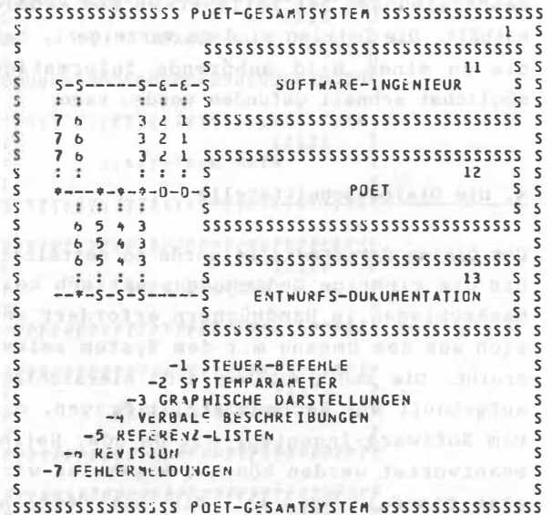
Bild 2: Struktur des Gesamtsystems für Grobentwurf und Dokumentation von PEARL-Programmen mit den Informationskanälen, welche die drei Teile verbinden. Die Verfeinerung von POET wurde bereits in Bild 1 gezeigt.
