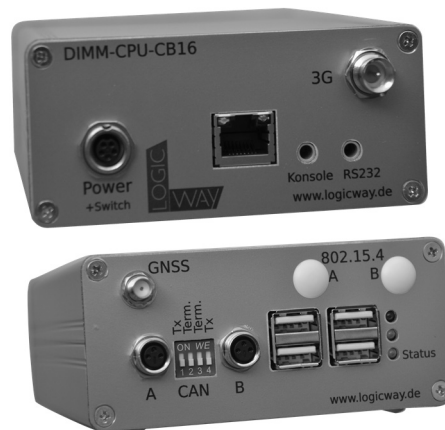
Abb. 1: Maschinen-Kommunikationsmodul, auf dem der Softwarestack implementiert und erprobt wurde (CPU: ARM Cortex A8, 2xCAN, LAN, LTE, Buildroot Linux)
