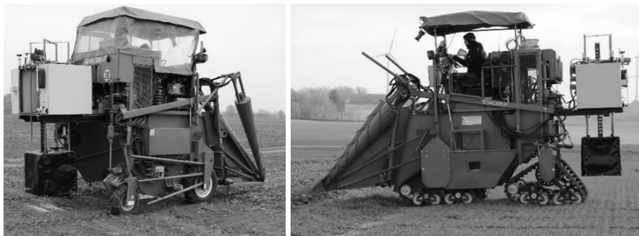
Abb. 1: Entwickeltes und verbautes Sensorsystem an zwei verschiedenen Fahrzeugen im Feldeinsatz; (links) bei der DSV; (rechts) bei der NPZ
