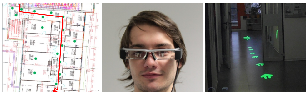
Abbildung 1: Position der Beacons im 1. OG der Versuchsumgebung in Grün, Pfad vom Aufzug zum Sekretariat in Rot (links), verwendete Durchsichtdatenbrille Epson Moverio BT-200 (mittig), prototypische AR-Navigation mit kontaktanalogen Navigationshinweisen aus der Sicht durch die Datenbrille (rechts)
