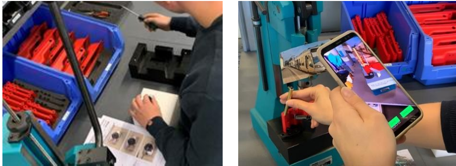
Abb. 3: Probanden während der Montage des Notgriffs mit Papieranleitung (links) und AR-Anleitung (rechts)
