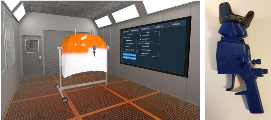
Abb. 3: (links) Ausschnitt der virtuellen Lackierpistole mit halb lackiertem Werkstück (rechts) gedruckte Lackierpistole mit Vive Tracker zur 3D-Ortung im Raum
