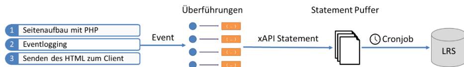
Abb. 1: Überföhrung von Moodle Events in xAPI Statements und Versenden an einen LRS
