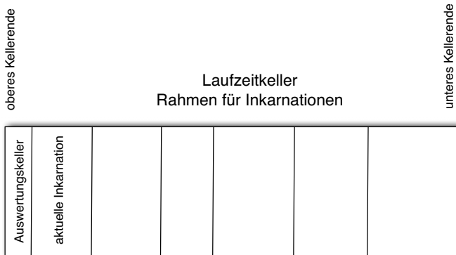
Abbildung 1: Ein Laufzeitkeller mit (kleinem) Auswertungskeller. Der Laufzeitkeller dient zur Unterstützung von Rekursion, der Auswertungskeller zur Auswertung oder zur Reduktion von Ausdrücken oder zur Unifikation von Termen.
