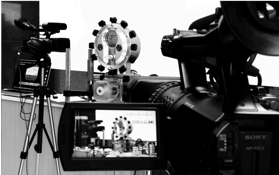
Abbildung 7: Versuchsaufbau des Gerätes für den Usability Test mit Markern für das Tobii Glasses Eye Tracking System
