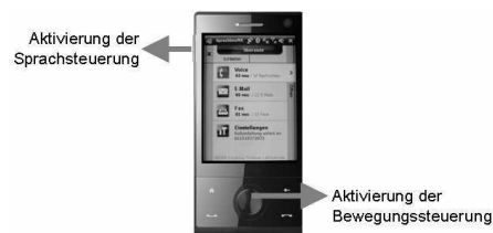
Abbildung 1: Testgerät und Zuordnung der relevanten Bedienelemente
