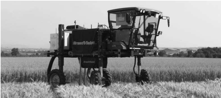
Abb.3: Phänotypisierungsplattform „BreedVision“ bei Feldtests 2015 in Hohenheim
