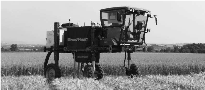
Abb.3: Phänotypisierungsplattform „BreedVision“ bei Feldtests 2015 in Hohenheim
