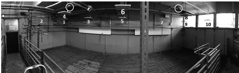
Abb. 1: Weitwinkelaufnahme der Versuchsbucht mit RFID-Antennen (1-10) und Videokameras (Kreise)
