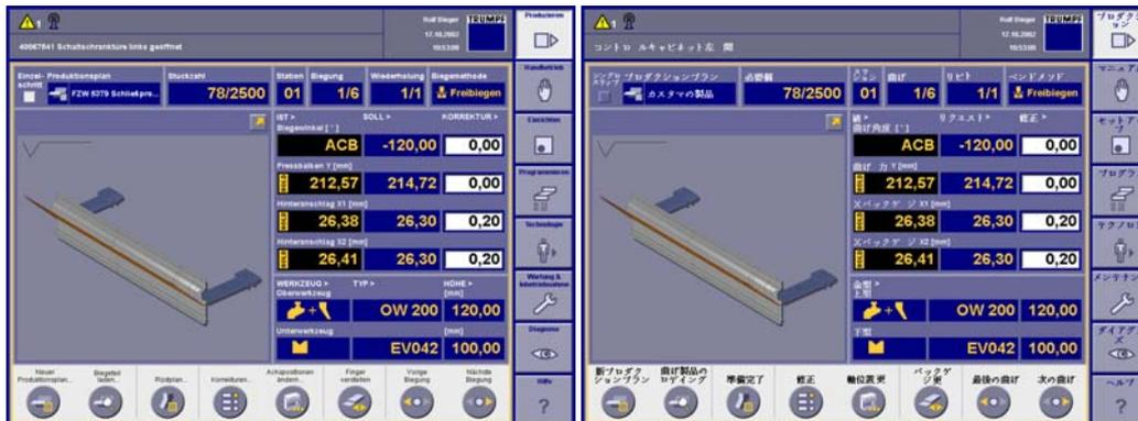
Abbildung 2: Produzieren-Screen mit Darstellung der Einlegeposition des zu biegenden Blechs (mit deutscher und mit japanischer Beschriftung unter Verwendung der Kanji- und Katakana-Schrift)
