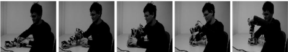
Abbildung 5: Ein Proband demonstriert einem Roboter eine Aufstehbewegung indem er dessen Gelenke bewegt.
