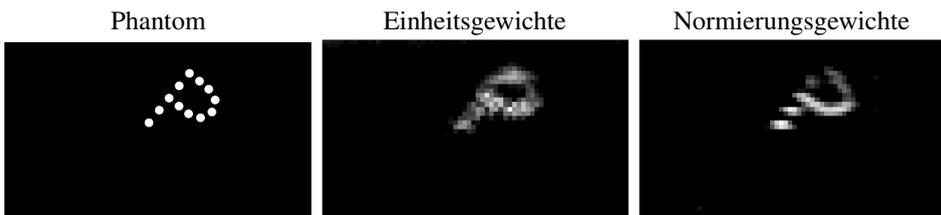
Abbildung 4: Rekonstruktionsergebnisse gemessener 2D-MPI-Daten mit und ohne Normierungsgewichte. Zum Vergleich ist eine schematische Zeichnung des verwendeten Phantoms dargestellt.
